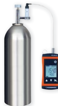
kalibrace zkušebním plynem
